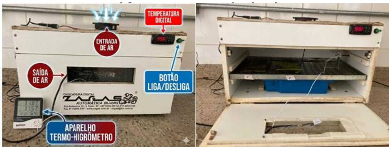
FIGURA 2. Prototipagem da chocadeira de ovos adaptada para o processo de cura das favas.
