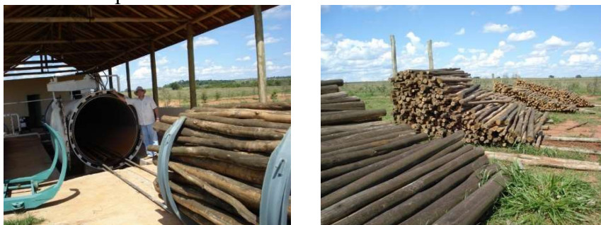
Foto 10. Retirada da madeira da Autoclave e pátio de armazenamento. Fonte: Dados da Pesquisa (2019)
