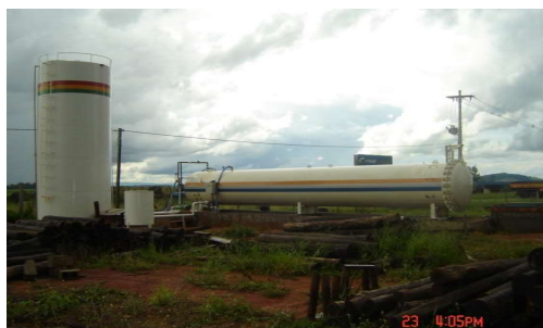
Foto 6. Autoclave e abastecimento da madeira em vagonetes para o tratamento. Fonte: Dados da Pesquisa (2019)
