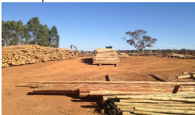
Foto 5. Madeira crua armazenada no pátio para secagem antes do tratamento. Fonte: Dados da Pesquisa (2019)
