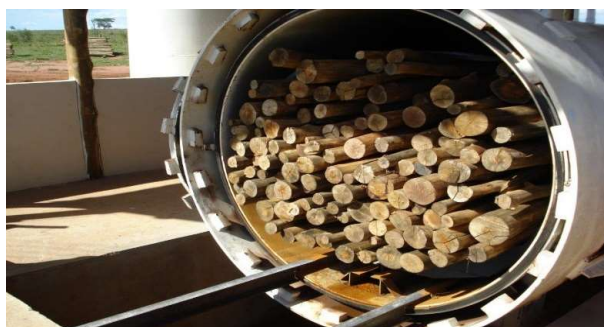
Foto 8. Autoclave abastecida com madeira para geração de vácuo.
