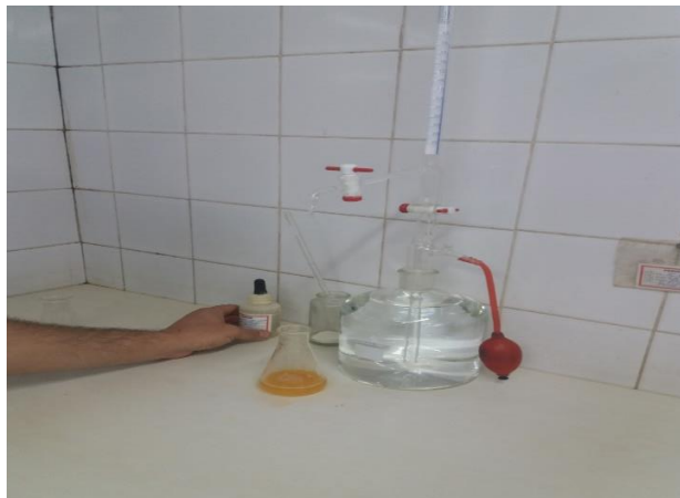
FIGURA 3. Determinação da acidez em laboratório pelo método da titulação. Fonte: Elaboração própria.
