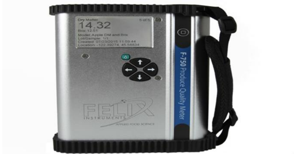
FIGURA 6. Medidor portátil de Brix e Acidez (marca Felix, modelo F750). Fonte: Tecnal.com.br.
